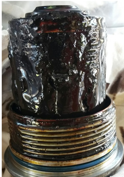
Slika 20 Začepljen pročistač ulja [25]
