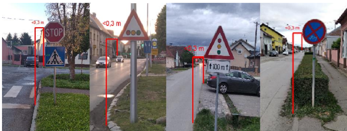
Slika 23. Prometni znakovi postavljeni na udaljenosti manjoj od 0,3 metra
