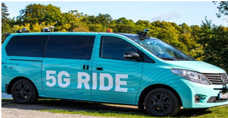
Slika 18. Autonomni električni 5G mini bus Kelios
