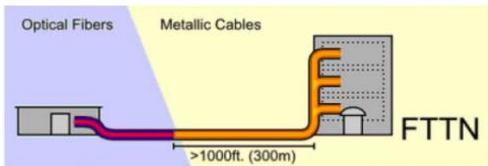
Slika 6. Optičko vlakno do ormarića/distribucijskog čvora Fiber to the Cabinet/Node.
