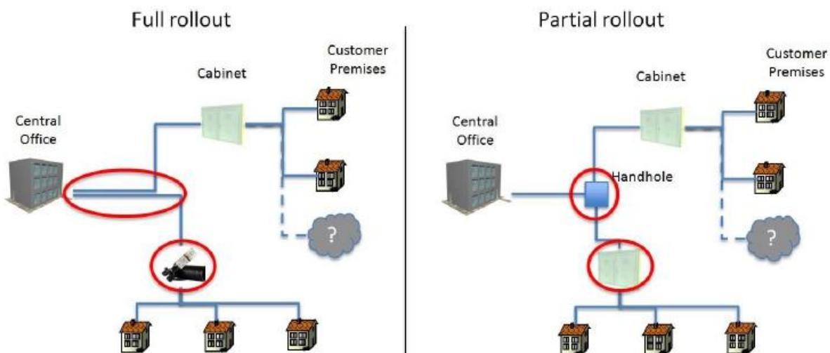
Slika 13. Cjelovito<sup>6</sup> uvođenje (*full rollout*) u odnosu na djelomično<sup>7</sup> uvođenje (*partial rollout*) optičke mreže. Preuzeto od [5].
