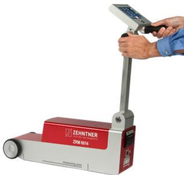
Slika 19. Uređaj za ispitivanje kvalitete oznaka na kolniku ZRM 6014
