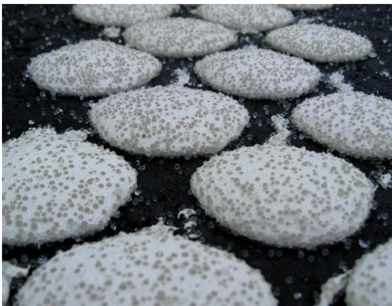
Slika 8. Staklene kuglice umetnute u materijal
