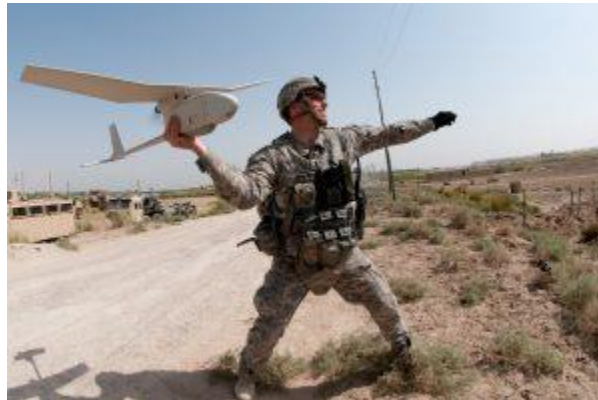
Slika 5. Izbacivanje drona iz ruke prilikom polijetanja
