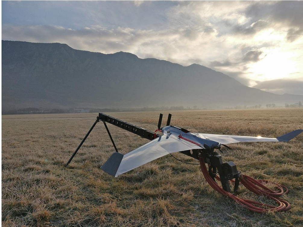
Slika 24. Bramor sAR na katapultu za lansiranje
