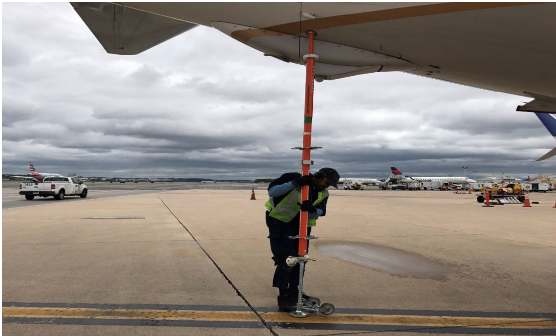
Slika 37. Postavljanje repnog podupirača zrakoplova Izvor: [26]
