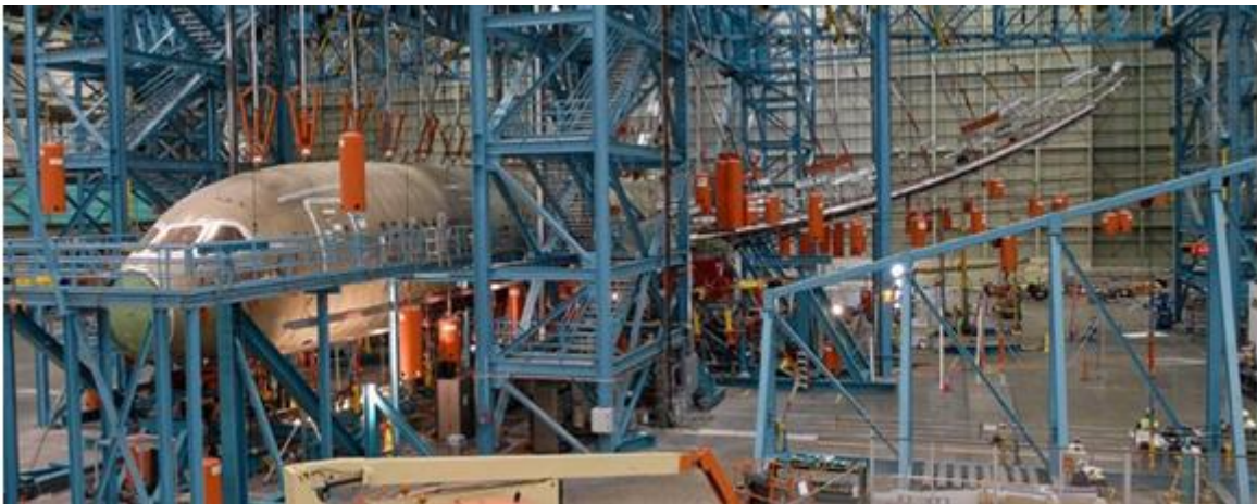
Slika 10. Ispitivanje statičke čvrstoće konstrukcije zrakoplova
