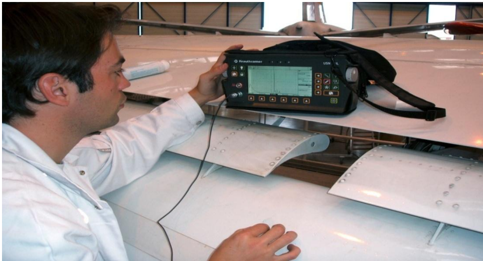
Slika 9. Ne-destruktivna inspekcija strukture zrakoplova
