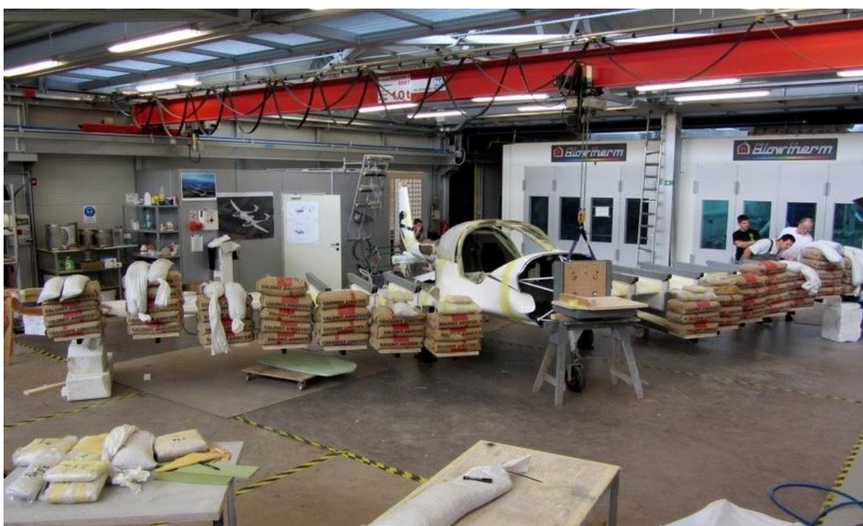
Slika 14. Ispitivanje statičke čvrstoće konstrukcije
