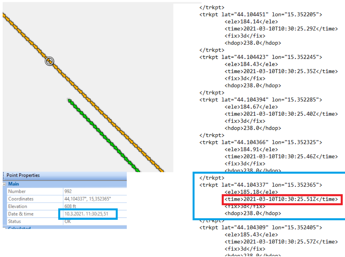
Slika 6.2. Točka u programu GPX Track Editor i u GPX zapisu
