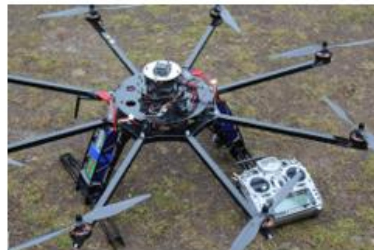
C) Octocopter-ručne izrade
