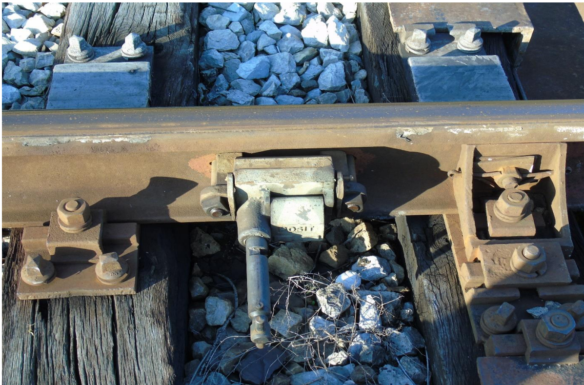
Slika 22. Skretnička brava tipa „Robel“ u otključanom položaju
