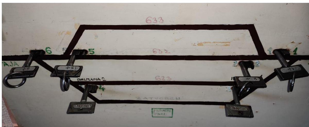
Slika 17. Shema kolosijeka sa ključevima skretnica
