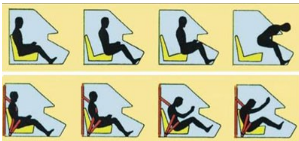
Slika 10. Kretanje vezanog i nevezanog tijela sigurnosnim pojasom
