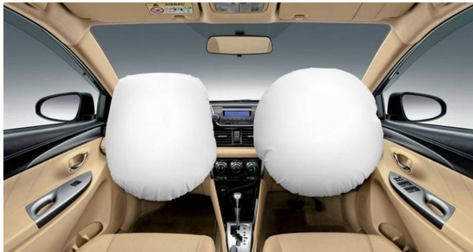
Slika 12. Aktivirani zračni jastuci u vozilu
