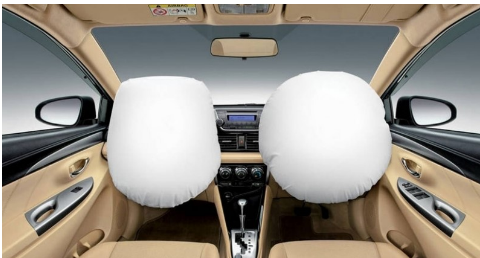
Slika 12. Aktivirani zračni jastuci u vozilu
