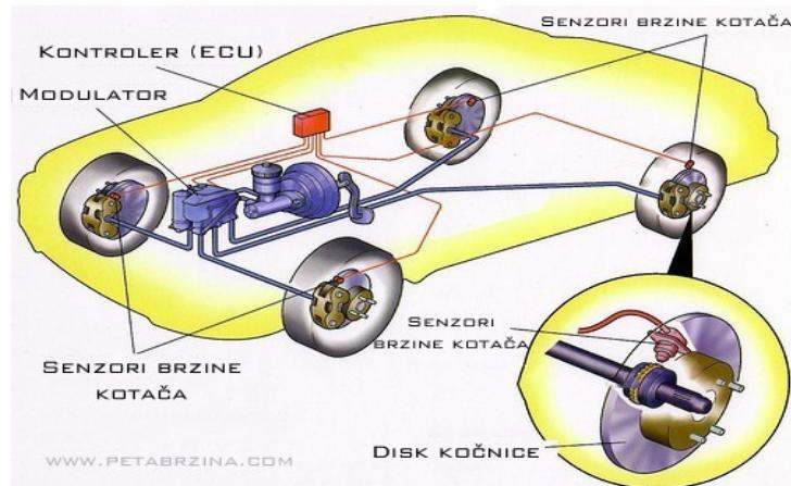
Slika 2. ABS – Sustav protiv blokiranja kotača
