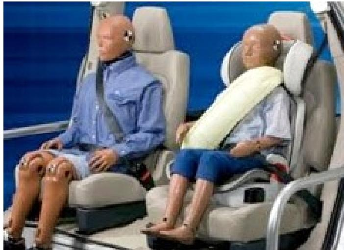
Slika 7. Sigurnosni pojaz sa ugrađenim zračnim jastukom
