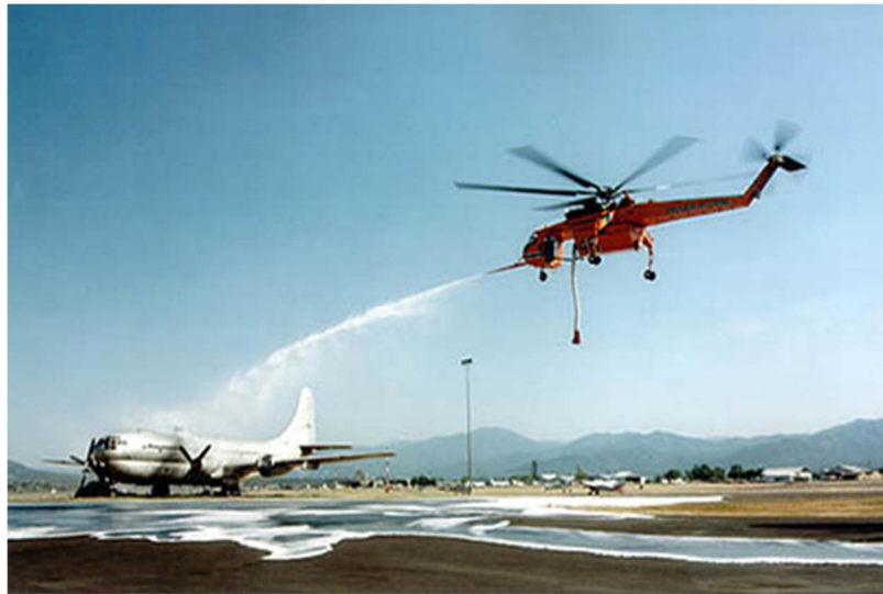
Slika 9. Modifikacija vodenim topom
