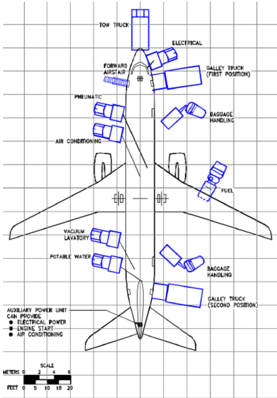
Slika 1. Oprema za prihvati i otpremu zrakoplova B737-800, [3]
