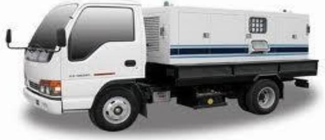
**Slika 5.** Samohodni agregat, [3]
