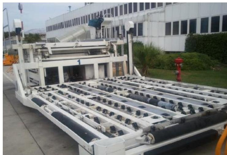
**Slika 12.** Utovarivač cargo-platforma, [3]
