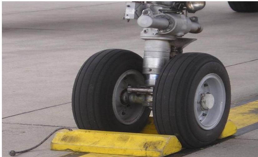
**Slika 2.** Podmetači podmetnuti pod kotače zrakoplova [16]
