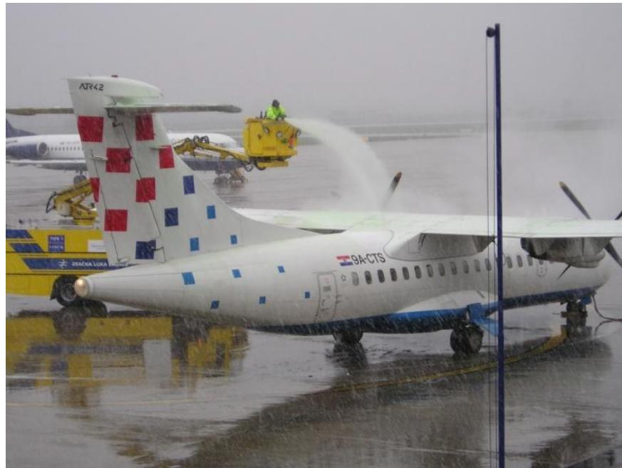
**Slika 19.** Anti-icing zrakoplova, [27]
