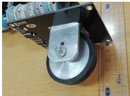
Slika 18. RFID sustav na dnu elektroničkog štapa, [34]
