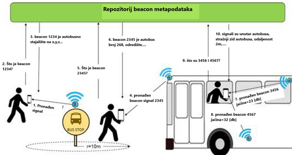
Slika 30. Korištenje Bluetooth beacona u javnom gradskom prijevozu, [41]
