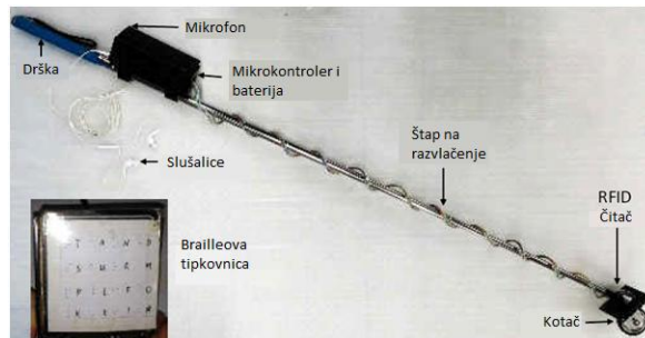
Slika 19. Prikaz elektroničkog štapa i njegovih komponenti, [34]
