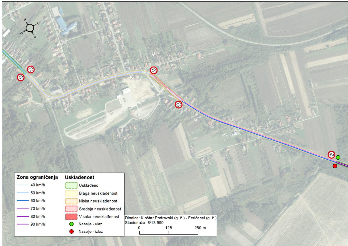
Slika 5. Primjer neusklađenosti ograničenja brzina na DC2 -lokacija 1
