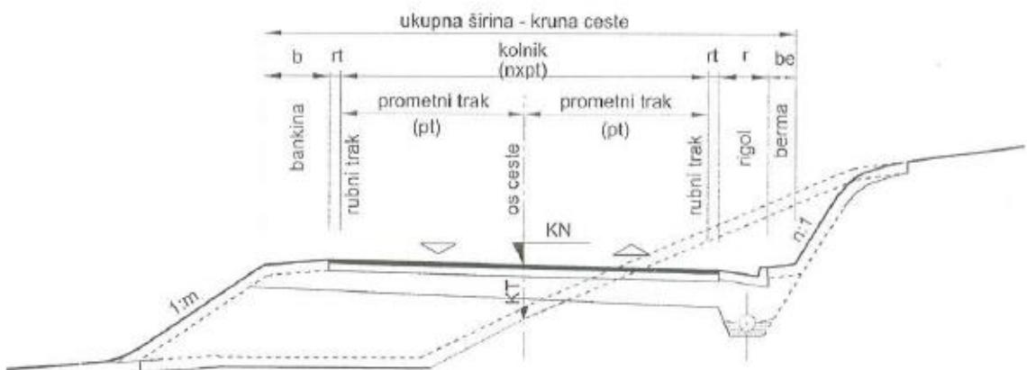
Slika 1.: Osnovni elementi poprečnog presjeka ceste
