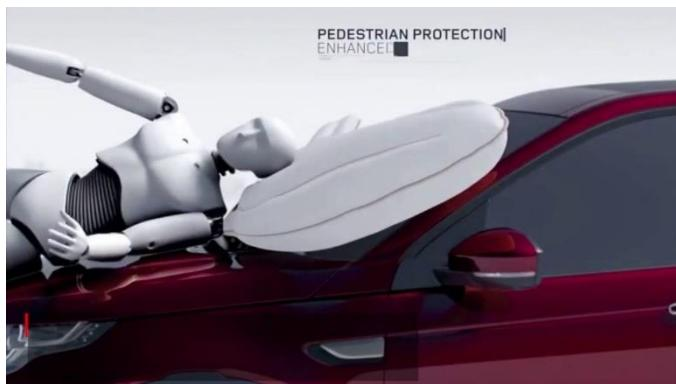
Slika 58. Princip rada zračnog jastuka za pješaka
