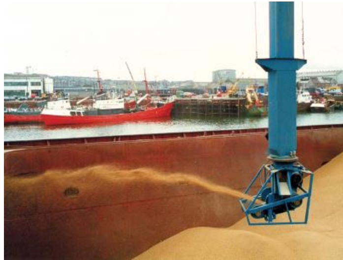
Slika 57. Sustav ukrcanja dovodne cijevi sa krakom
