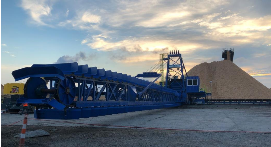
Slika 48. Sustav uređaja za povrat s trakastim transporterom
