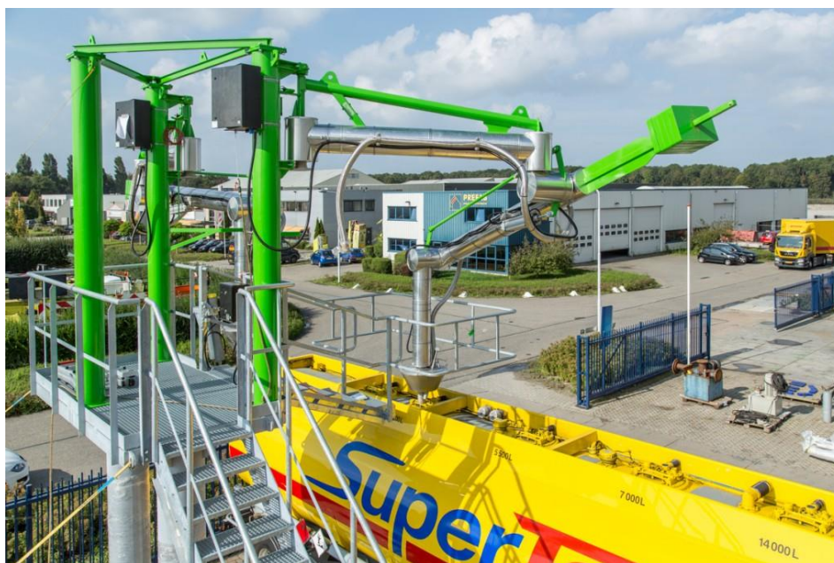
Slika 68. Ukrcaj tekuće rasute biomase za transport cisternom
