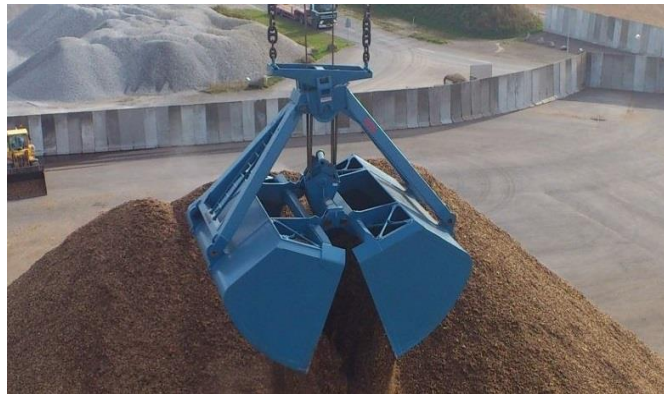
Slika 23. Zatvorena zahvatna grabilica
