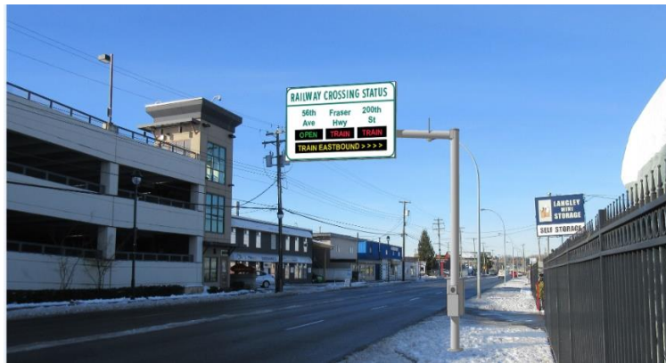
Slika 27. Displej s informacijama o dolasku vlaka na željezničko-cestovni prijelaz [31]
