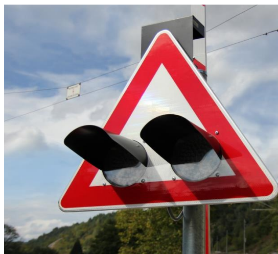
Slika 12. Cestovni signal CS-LHR [6]
