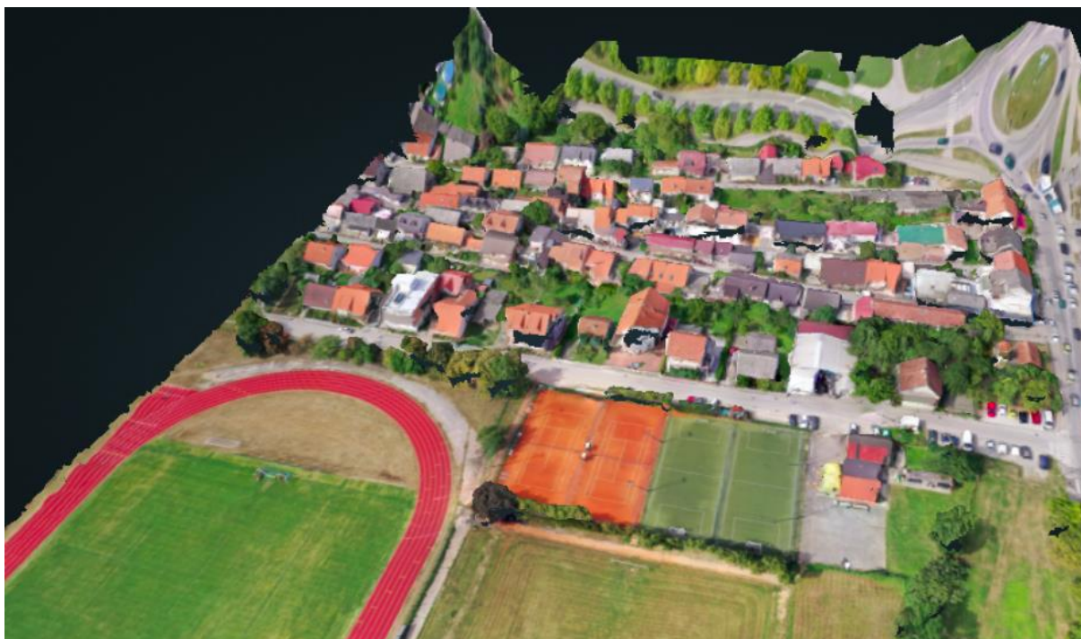
Slika 34. Generirani 3D model prikazan u WebODM pregledniku
