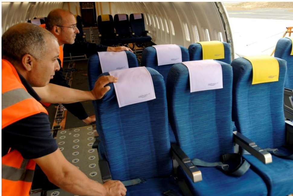
Slika 7. Proces izuzimanja sjedala kod quick change zrakoplova, [10]
