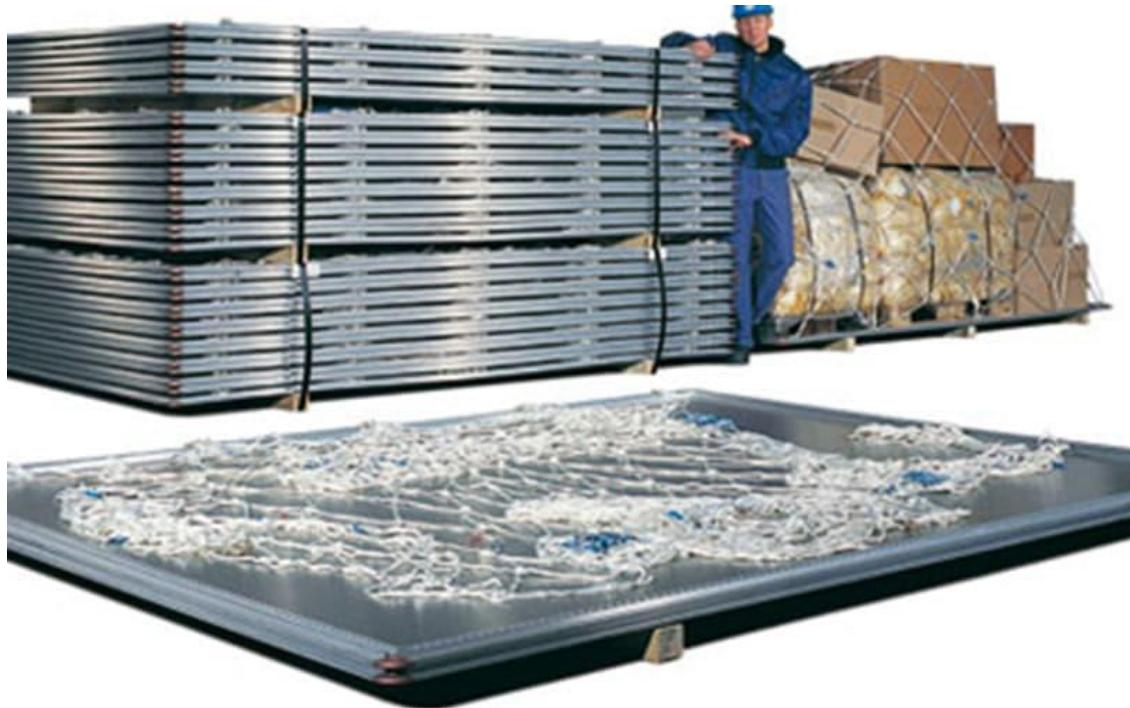
**Slika 8.** Izgled ULD zrakoplovnih paleta, [11]
