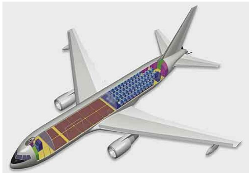
**Slika 6.** Prikaz unutrašnjosti kombiniranog zrakoplova, [9]
