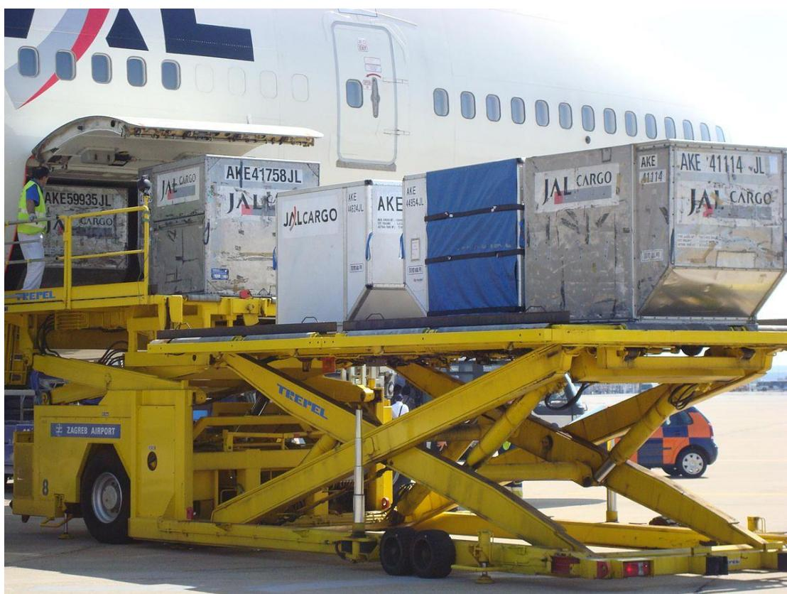
**Slika 1.** Istovar ULD kontejnera iz zrakoplova, [3]
