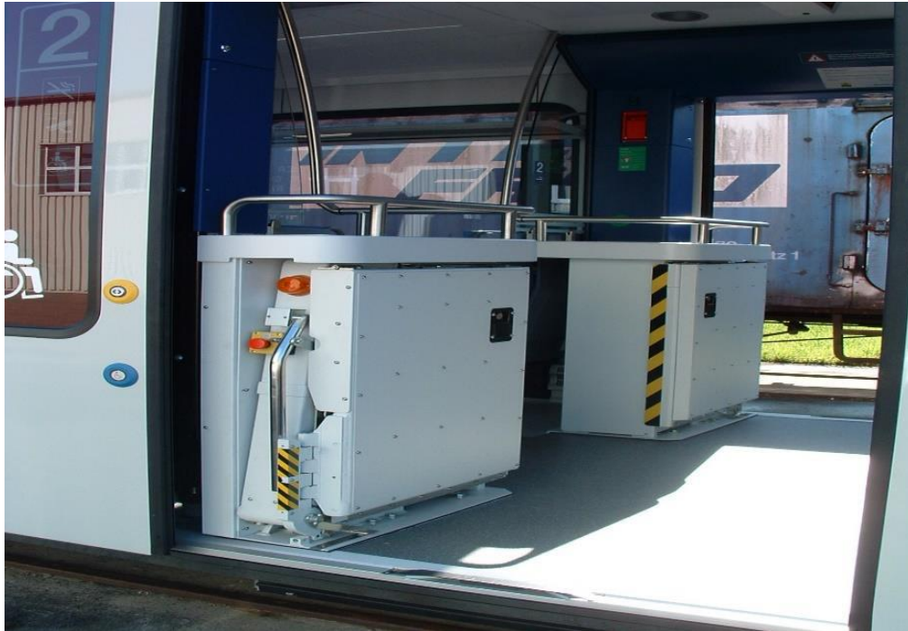
Slika 14: Prikaz rampe za ukrcaj ljudi sa smanjenom pokretljivošću u vlaku [4]
