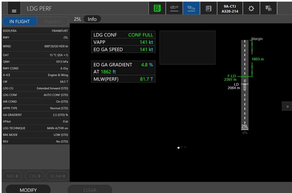
Slika 33: FlySmart sučelje s proračunima za slijetanje sa Zračne luke Frankfurt na temelju uvjeta A-ICE = Engine & Wing
