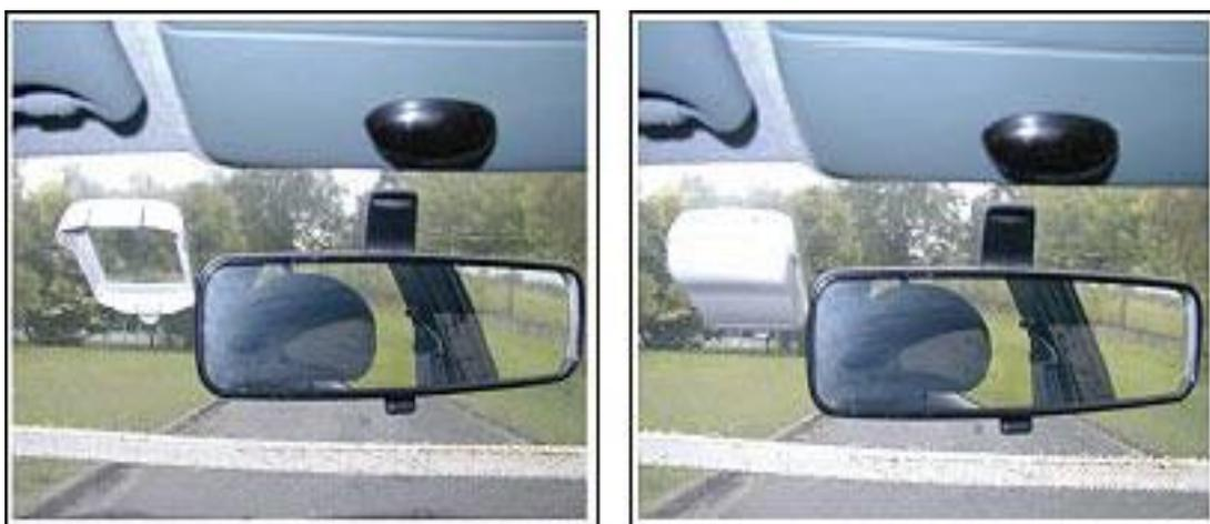
Slika 3. Prikaz ENC uređaja u vozilu; (72)
