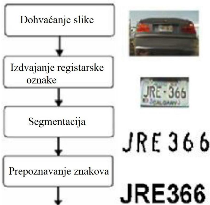
Slika 8. Princip rada ANPR sustava
