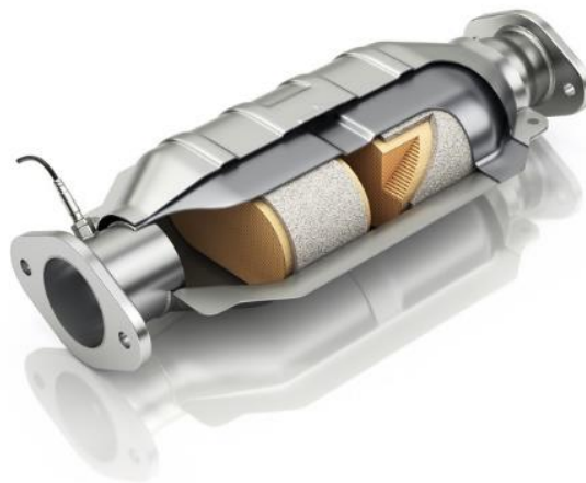
Slika 5. Katalizator za smanjenje štetnih ispušnih plinova, [16]
