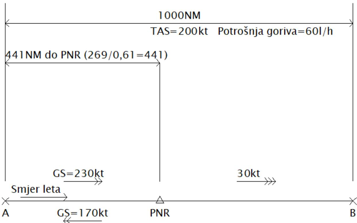
**Slika 3.** Skica primjera izračuna točke bez povratka
