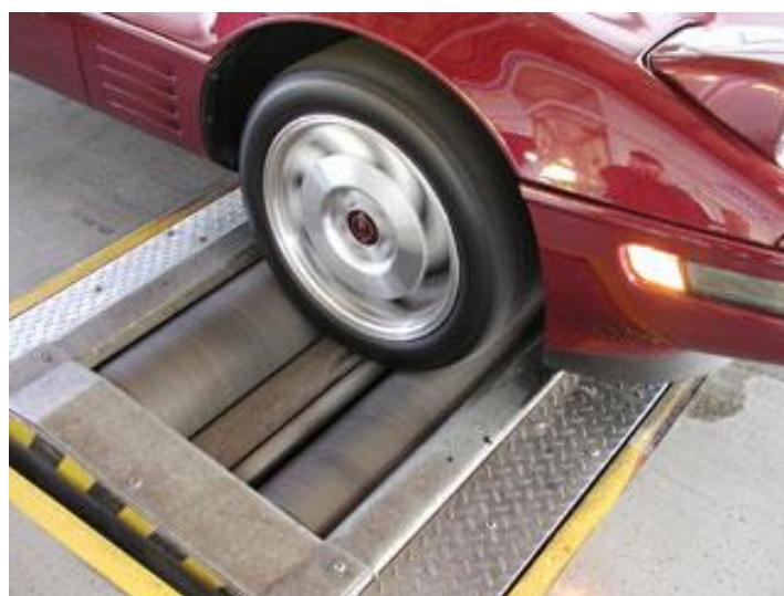
**Slika 1.** Valjci za ispitivanje kočne sile
