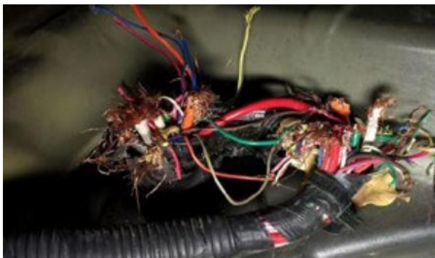
**Slika 12.** Oštećeni i neizolirani električni vodovi
