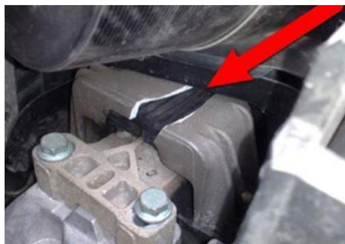
**Slika 11.** Oštećenje na metalnom nosaču motora
