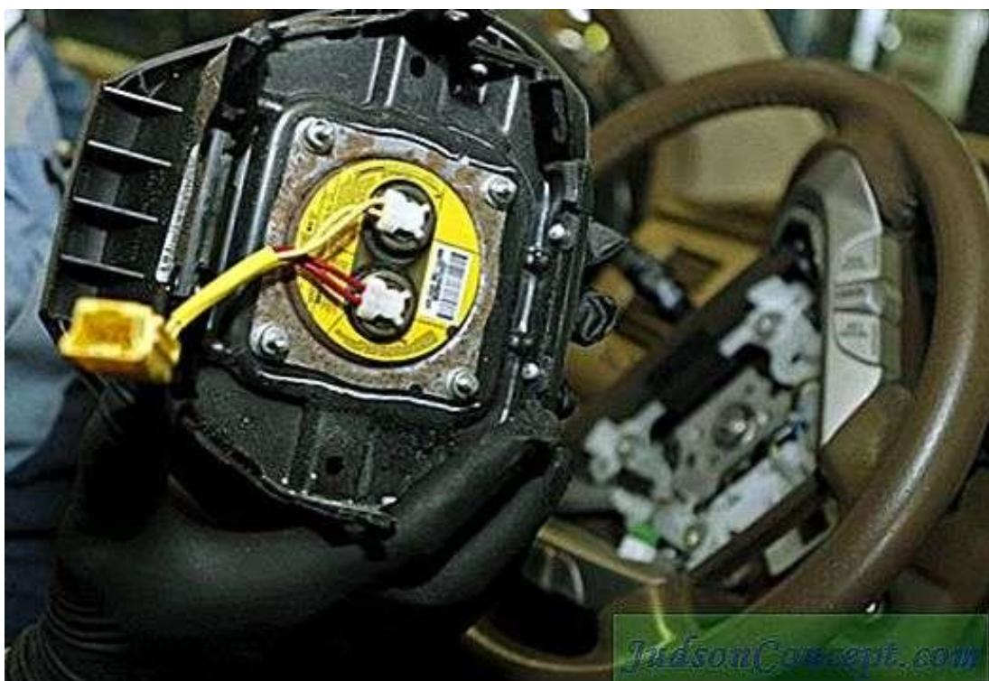
**Slika 14.** Mehanička provjera zračnog jastuka
