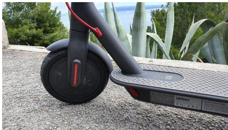
Slika 5. Motor električnog romobila smješten na prednjem kotaču
