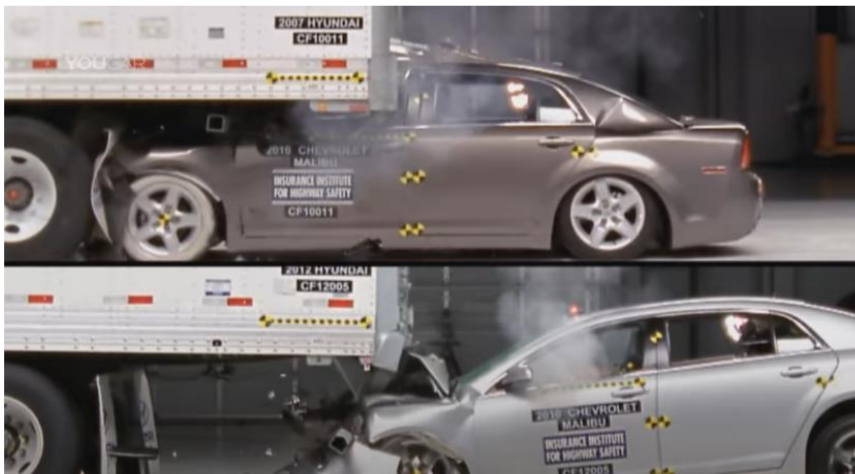
Slika 33: Utjecaj stražnje zaštite od podlijetanja
