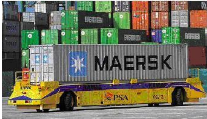
Slika 11. Automatski vođeno vozilo za transport kontejnera
