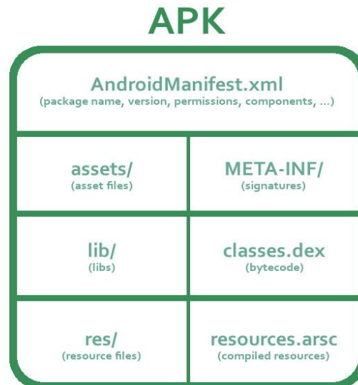
Slika 12. Osnovne komponente APK datoteke, [21]
