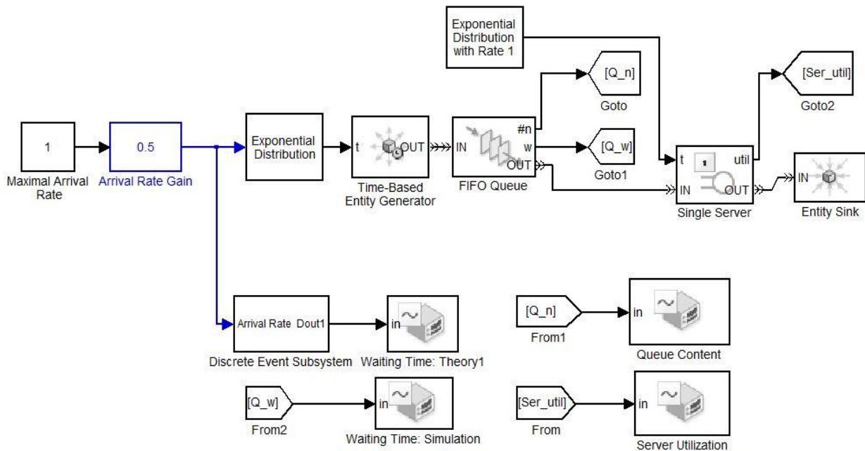
Slika 7. Shematski prikaz preddefiniranog modela  $M|M|1|\infty|\infty|FCFS$  u Simulinku
