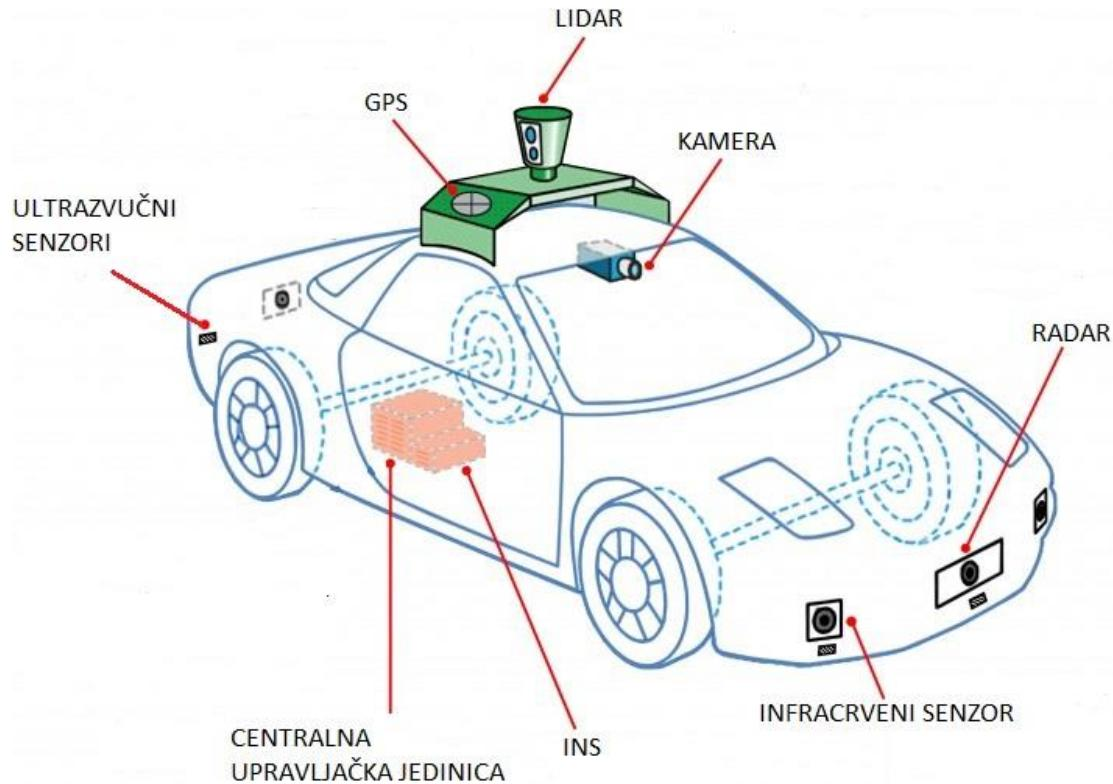
*Slika 1 Prikaz senzora na autonomnom vozilu [15]*
