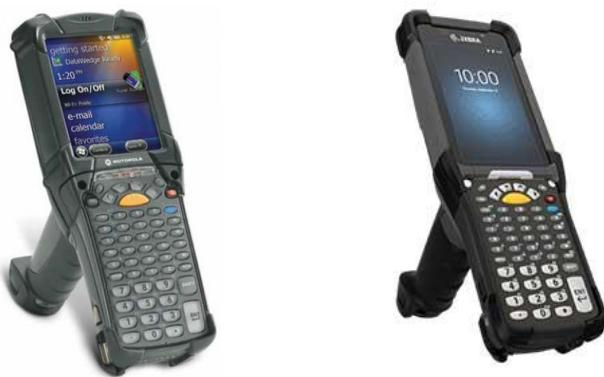
Slika 21. RF uređaji koji se koriste prilikom skeniranja i pregledavanja robe (uređaj lijevo Motorola MC9200, uređaj desno MC9300)
