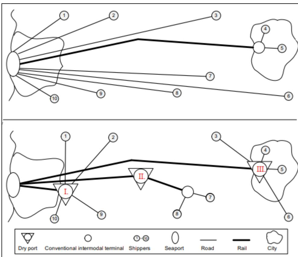
**Slika 2:** Usporedba između konvencionalnog prometa zaleda (slika gore) i primjenjenog koncepta pozadinskih terminala (slika dolje)
