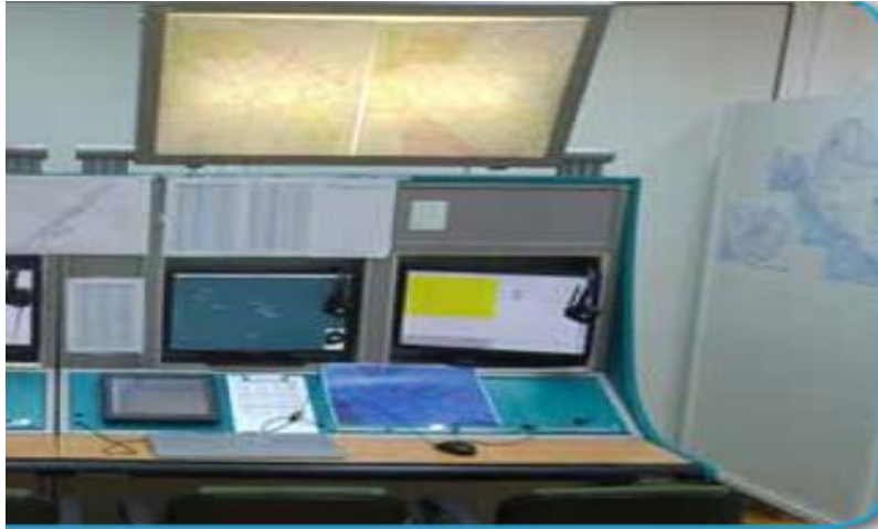
Slika 2. Simulator za radarsku kontrolu zračnog prometa Izvor: [7]
