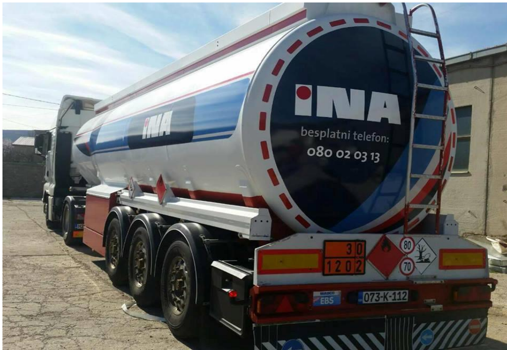
Slika 20. Označavanje autocisterne za prijevoz naftnih derivata
