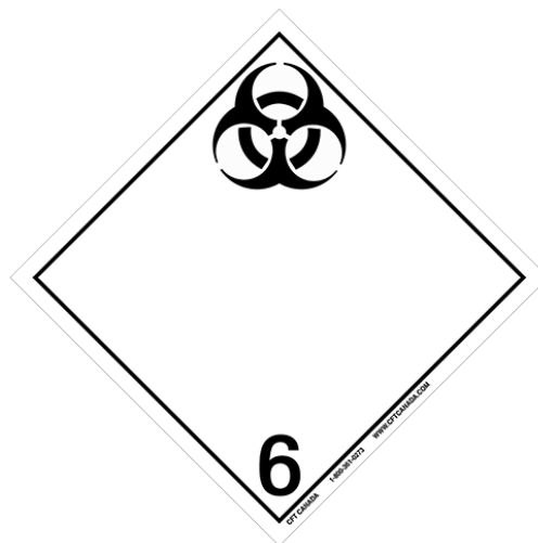
Slika 8. Listica opasnosti za infektivne tvari
