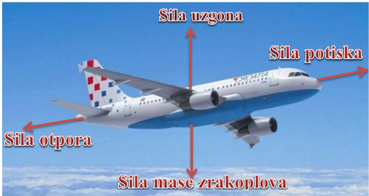
Slika 1. Sile koje djeluju na zrakoplov u letu
