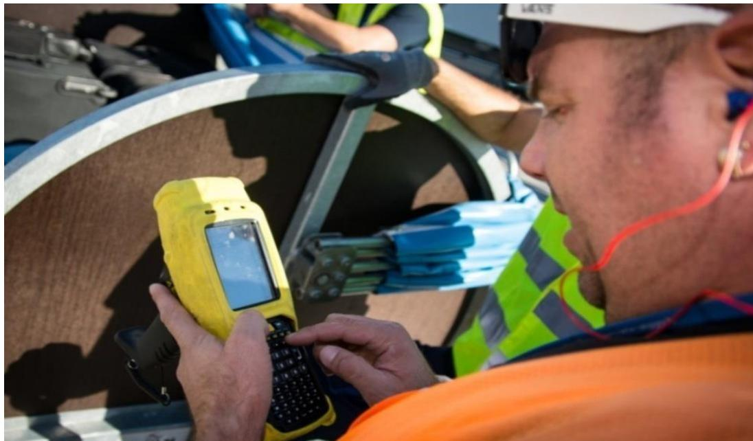
**Slika 9.** PDA uređaj za praćenje utovara zrakoplova, [13]
