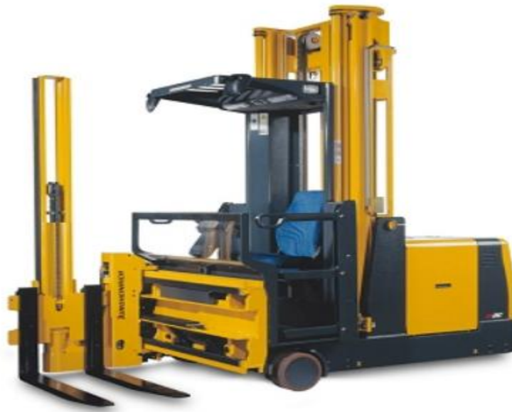
Slika 9. Viličar sa zakretnim vilicama [3]
