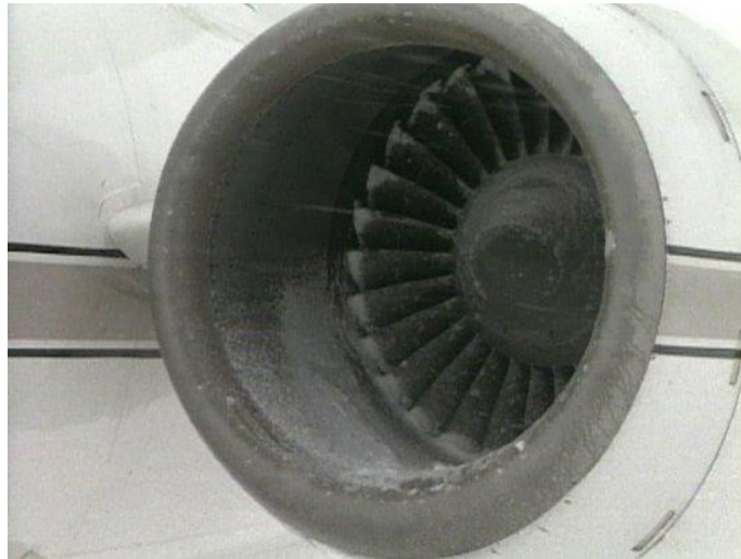
Slika 4. Pojava leda na motoru pri niskim temperaturama [10]
