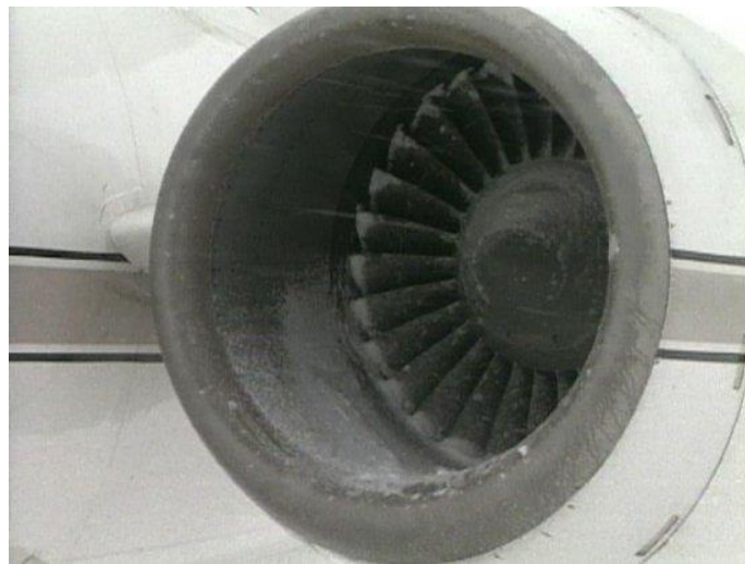
Slika 4. Pojava leda na motoru pri niskim temperaturama [10]
