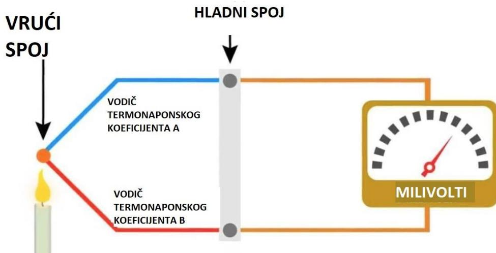
Slika 5. Pojednostavljeni princip rada termonaponskog termometra [16]
