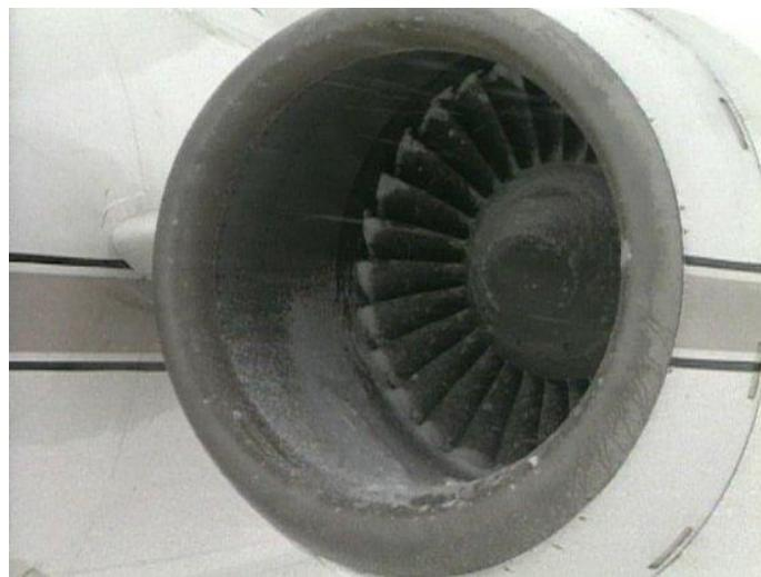
Slika 4. Pojava leda na motoru pri niskim temperaturama [10]
