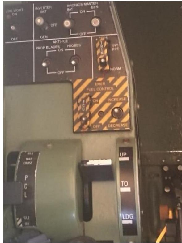
Slika 10. Prekidači sustava za sprječavanje zaledivanja
