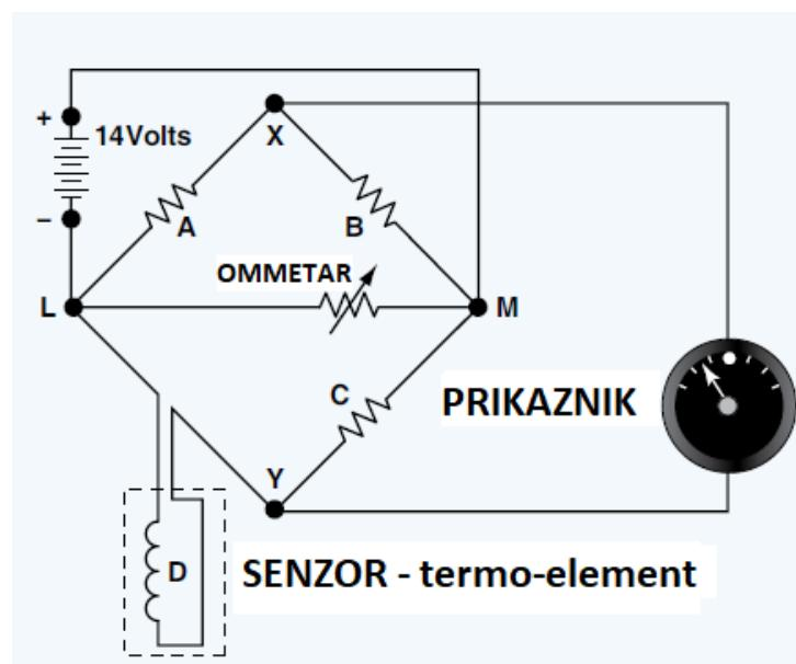
Slika 2. Pojednostavljena shema otporskog termometra [2]
