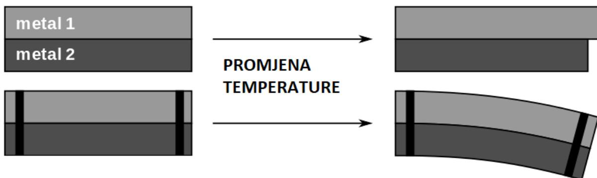
Slika 1. Jednostavni prikaz bimetalnih vrpcu prilikom promjene temperature [6]
