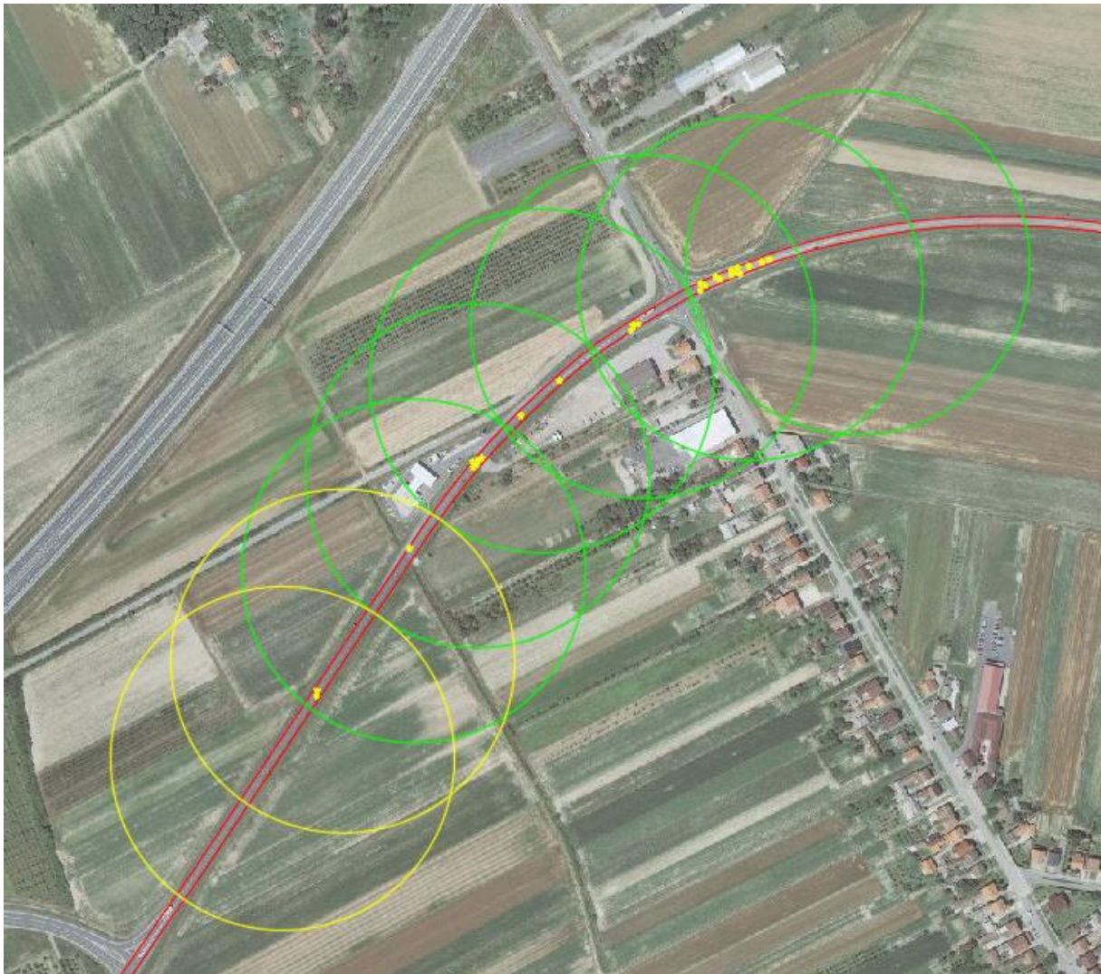
Slika 12. Prikaz identificirane opasne dionice pomoću segmentacijske metode Sliding window
