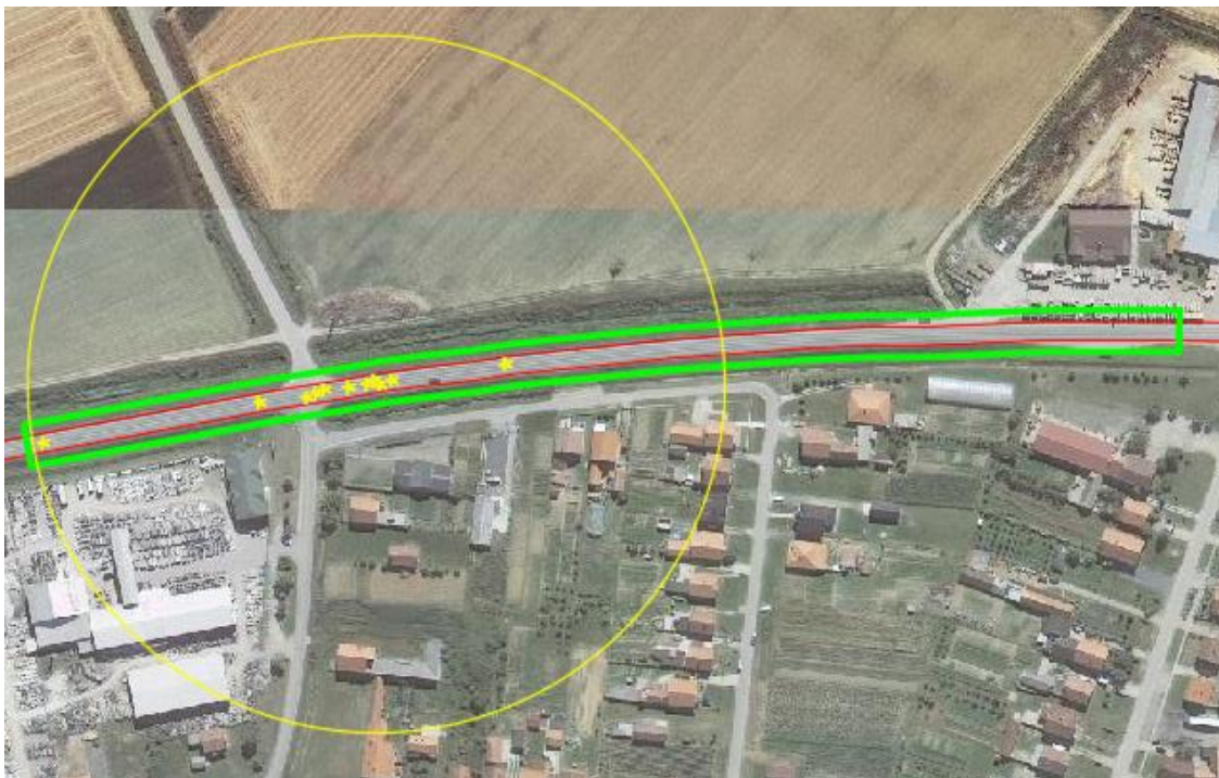
Slika 13. Usporedba utjecaja duljine segmenta na preciznost identifikacije opasnog mjesta
