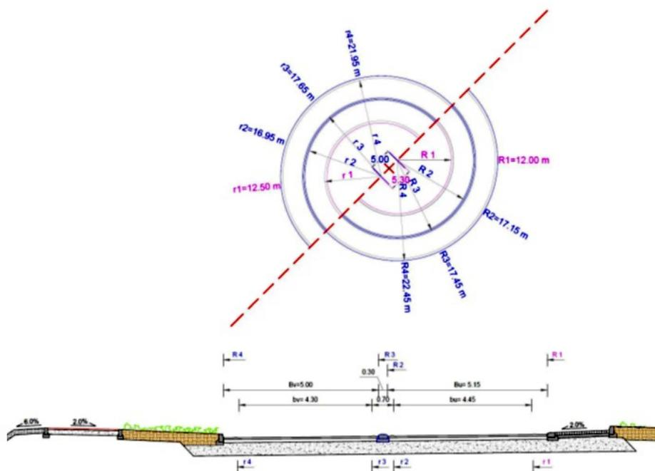
*Slika 22. Elementi i dimenzije standardnog turbo kružnog raskrižja*
