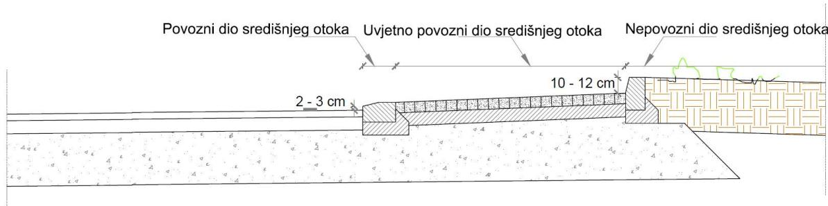
*Slika 30. Dijelovi središnjeg otoka turbo kružnog raskrižja*
