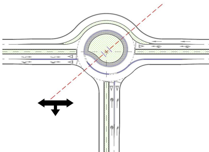
*Slika 16. Rastegnuti koljenasti tip turbo kružnog raskrižja*
