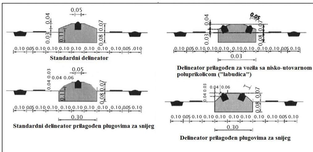
*Slika 7. Presjeci izvedbenih delineatora*
