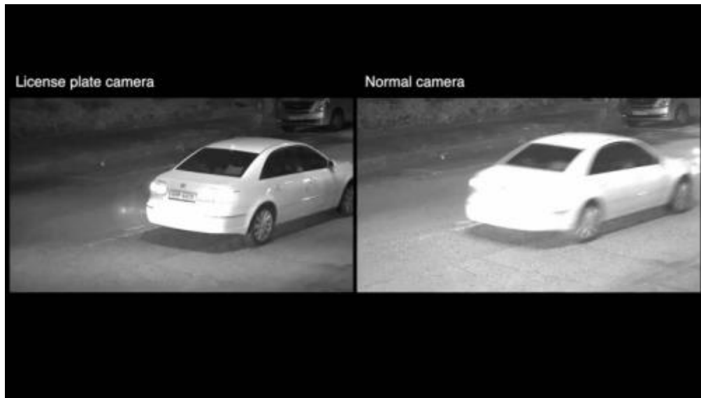
Slika 5. Infracrvena ANPR i obična kamera
