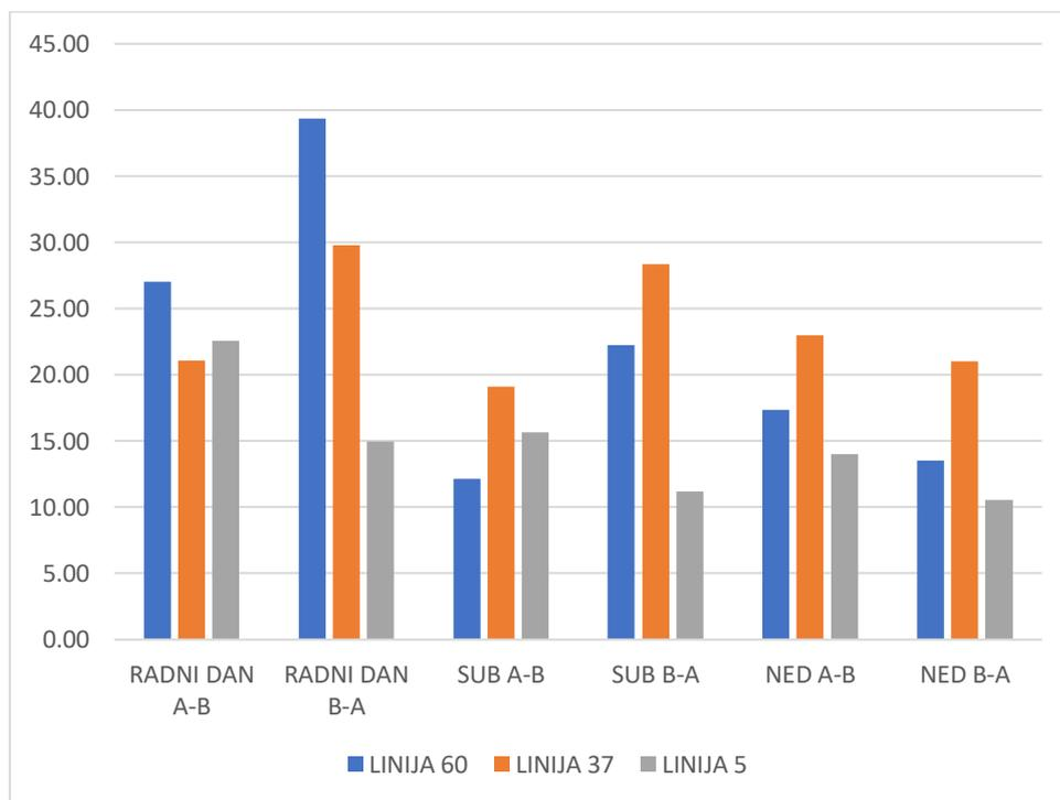
Grafikon 83. Prikaz usporedbe koeficijenta dinamičkog iskorištenja na svim linijama u izvan-vršnom satu
