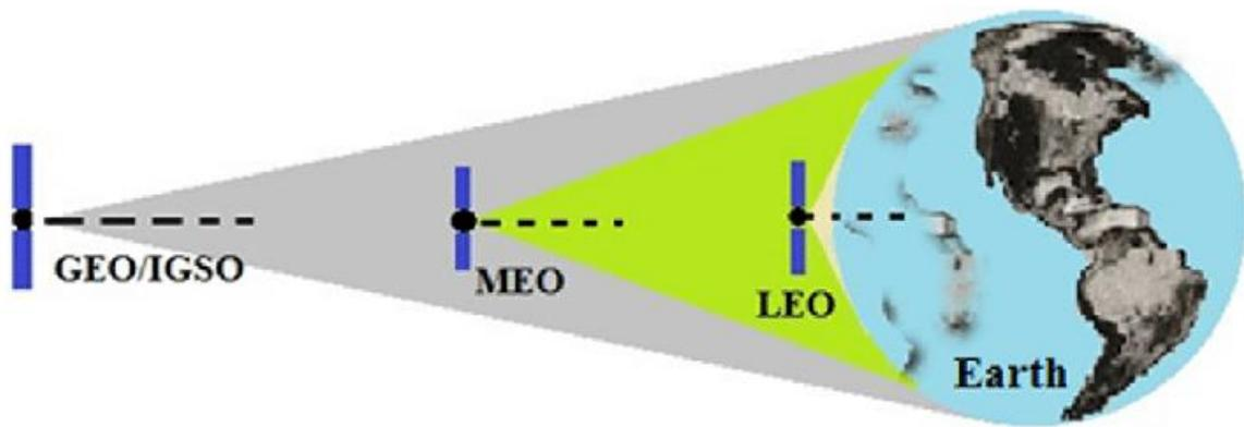
Slika 9 Ilustracija mogućih položaja satelita unutar Zemljinih orbita, [17]
