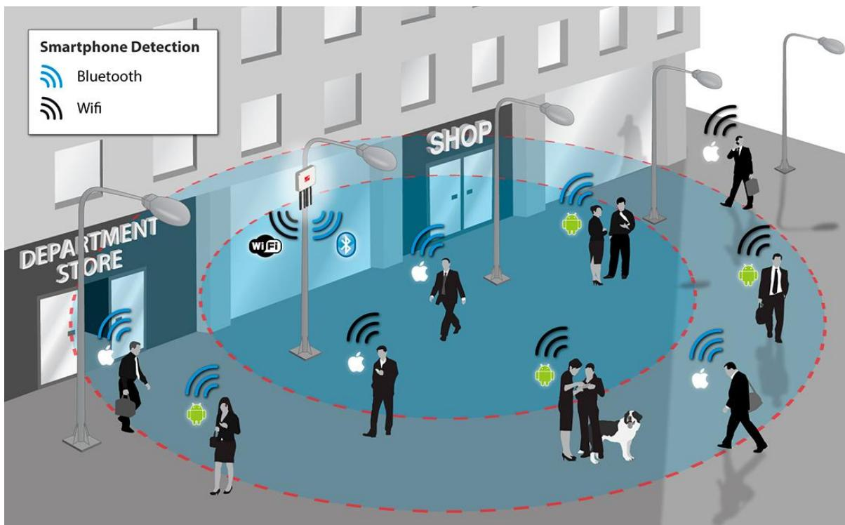
Slika 1. Sustav brojanja pješaka korištenjem BT detektora [20]
