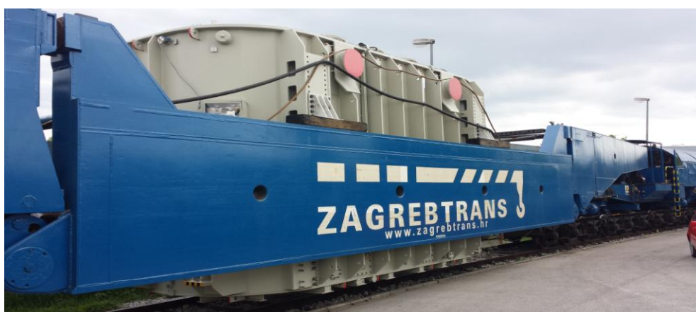
Slika 24. Transformator spreman za prijevoz Izvor: poduzeće ZAGREBTRANS
