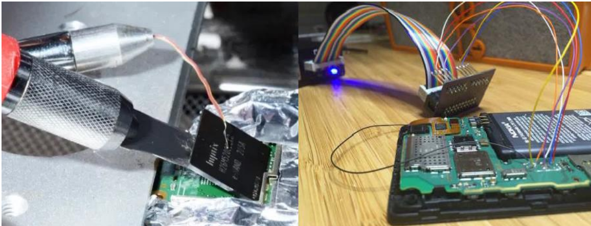
Slika 9. Primjeri Chip-Off i JTAG tehnika
