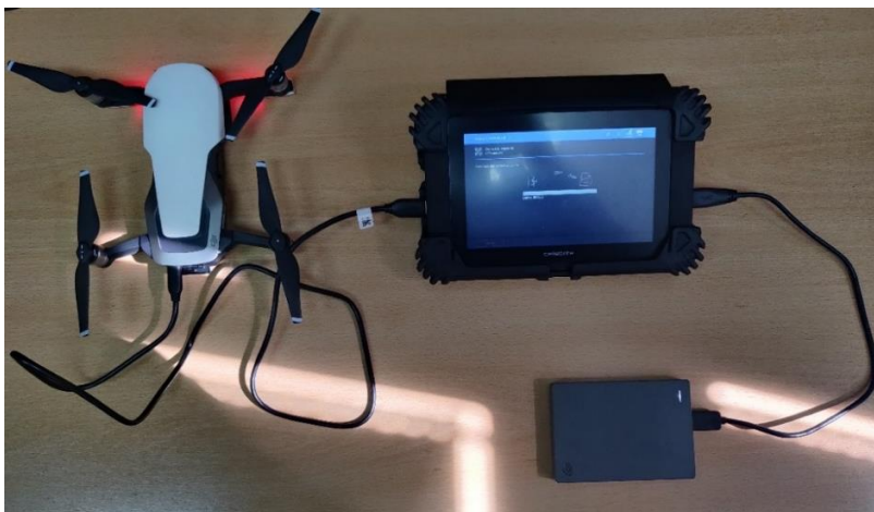
Slika 12. Izvođenje ekstrakcije pomoću UFED Touch 2 alata
