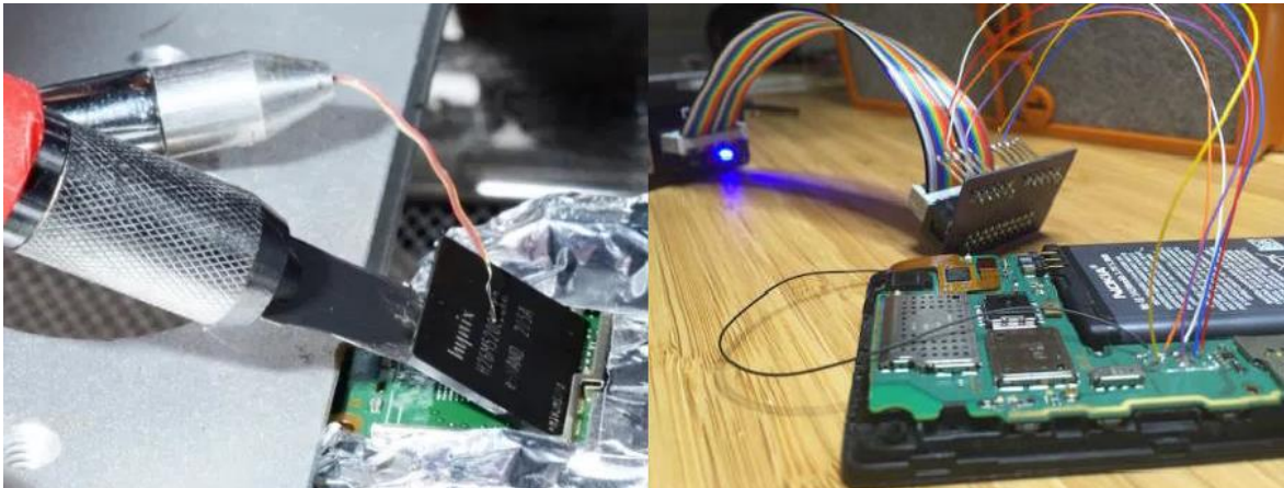
Slika 9. Primjeri Chip-Off i JTAG tehnika
