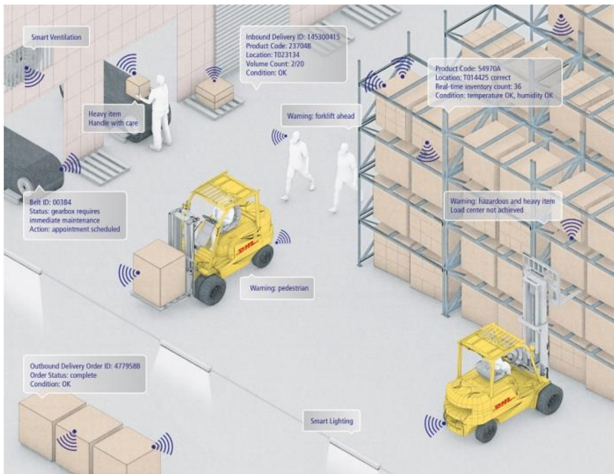
Slika 30. Terminal DHL opremljen IoT tehnologijom(WiFi tehnologija)
