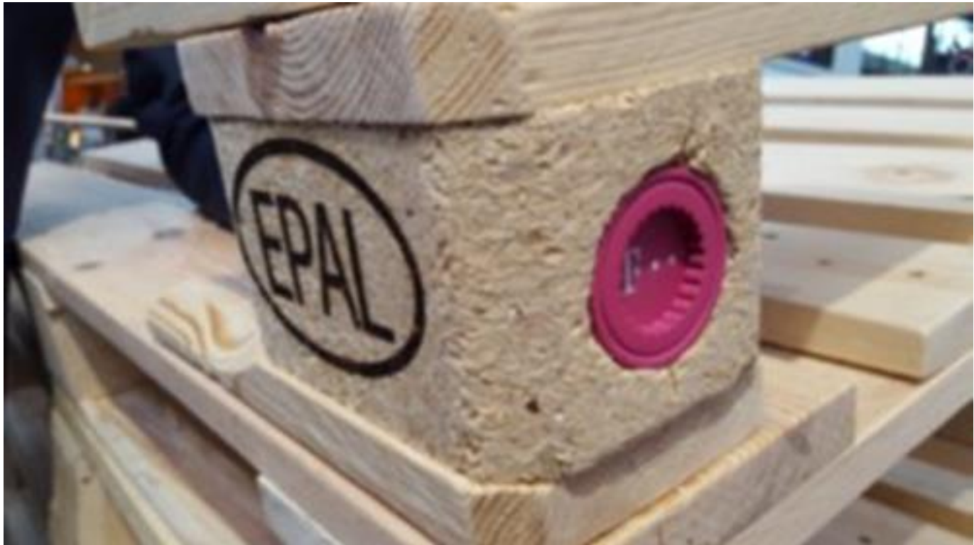
Slika 24. T-Mobile kit ugrađen u prednju kocku palete
