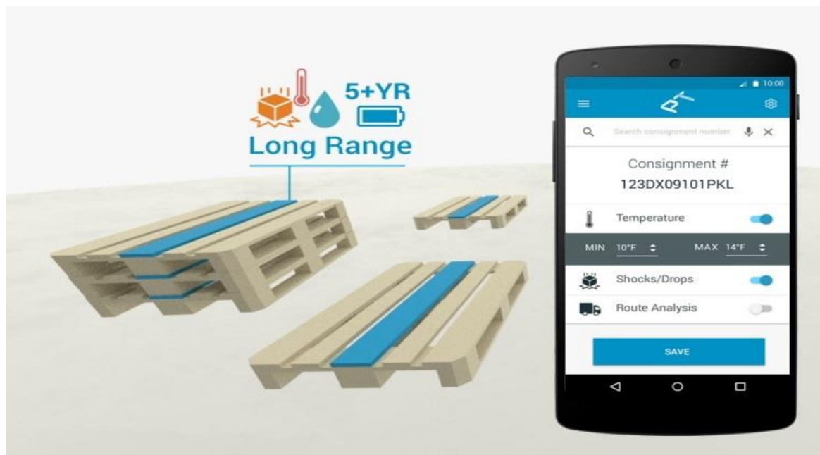
Slika 25. Senzori su ugrađeni u središnju dasku palete
